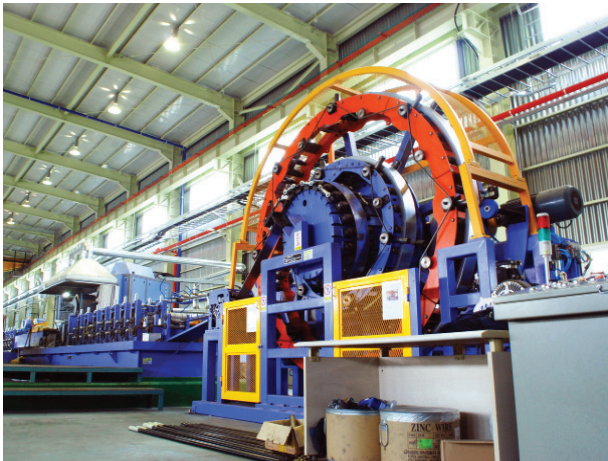
조관기 Skelp를 사용하여 원형관, 각관 등을 연속적으로 생산하는 자동화 설비
