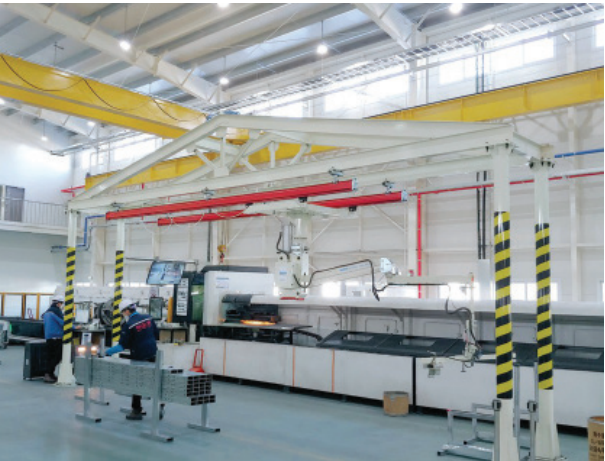
레이저 고중력 레이저로 원형관 및 각관의 길이 및 홀을 정밀하게 가공하는 설비
