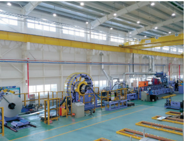
선타공 각관기 Skelp를 성형 전 단계에서 플라잉 편칭기를 이용해 정밀한 위치에 홀 가공을 선행함으로써, 생산 효율과 가공 정밀도를 동시에 확보하는 설비
